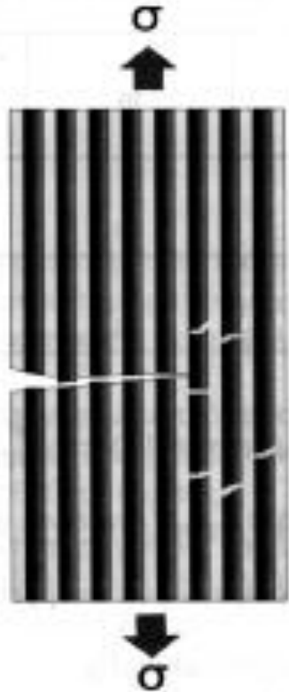
Εικόνα 6.19 Θραύση γειτονικών ινών λόγω συγκέντρωσης τάσεων στο άκρο της πρώτης ρωγμής.
